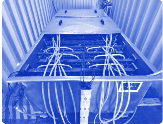
**Imagen 4.** Sistema bioelectroquímico que produce hidrógeno para la planta piloto de biometanación, dentro de las instalaciones de LIFE NIMBUS.
